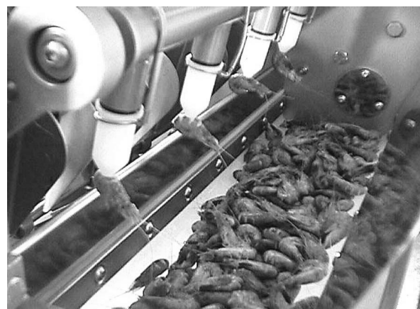
Abbildung 1: Gesamtansicht der Krabbenschälmaschine (links) und Garnelen beim Eintritt in die Maschine, durch Vakuum angesaugt (rechts oben) und nach dem Strecken in der Maschine (rechts unten) (Foto: I. van Woensel)
