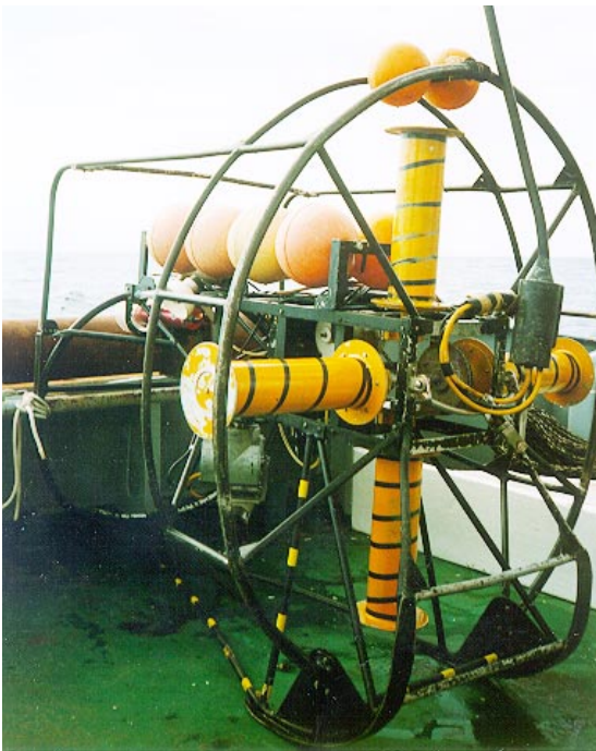
Abb. 4: Rotorgesteuerter, geschleppter Kamera-Schlitten auf FFK „Solea“
