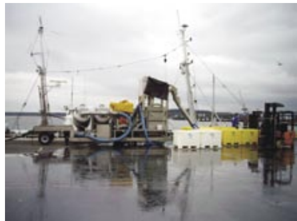
Abbildung 1: Heringsanlandung am Fischverarbeitungswerk Mukran mit Vakuumsauganlage – Landing of herring in the fish processing company in Mukran using a vacuum pump.
