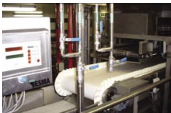
Abbildung 1: Bandwaage in der Euro-Baltic Fischverarbeitungs GmbH – Figure 10 Flow scale of the fish processing company Euro-Baltic..
