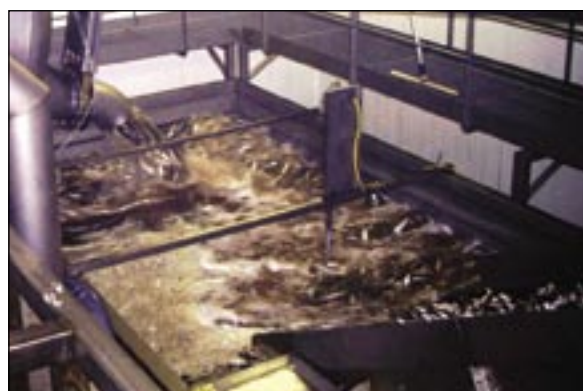
Abbildung 3: Auffangbecken mit Elevator – Figure 3: Storage tank with elevator.
