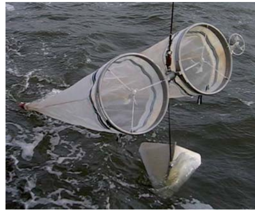
Figure 3: HYDROBIOS-Bongo net Abbildung 3: HYDROBIOS-Bongo Netz
