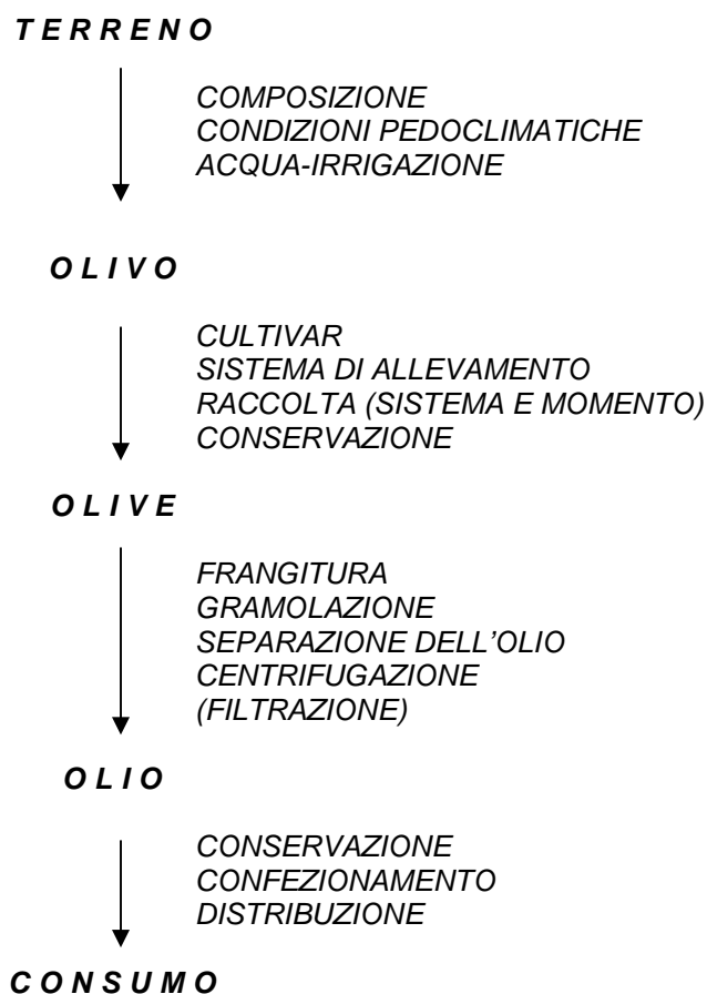
Schema 1 Filiere produttiva degli oli d'oliva, in relazione alla formazione delle caratteristiche di qualità degli oli al consumo
