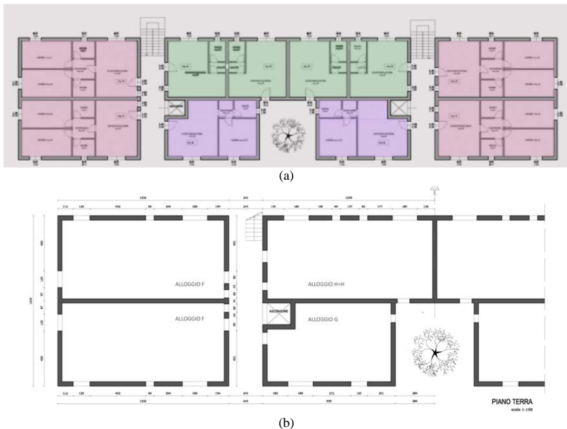
Figura 21.2. Pianta della tipologia A - PEDA: (a) architettonico con indicazione delle tre unità abitative (unità abitativa “ f ” in rosa; unità abitativa “ g ” in verde e unità abitativa “ h ” in viola); (b) strutturale.
