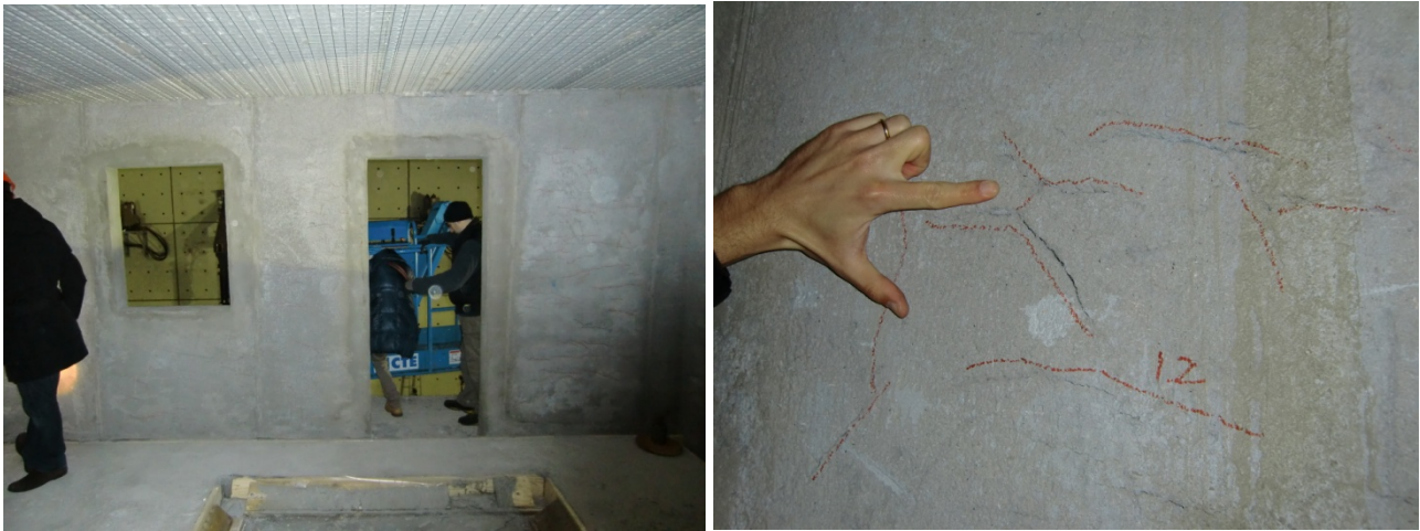
Figura 32.34. Foto delle pareti dopo il test a 1.2g: interno piano terzo.
