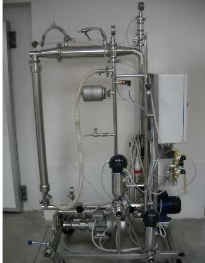
**Figura 33:** Impianto a ricircolo indiretto vista frontale e laterale
