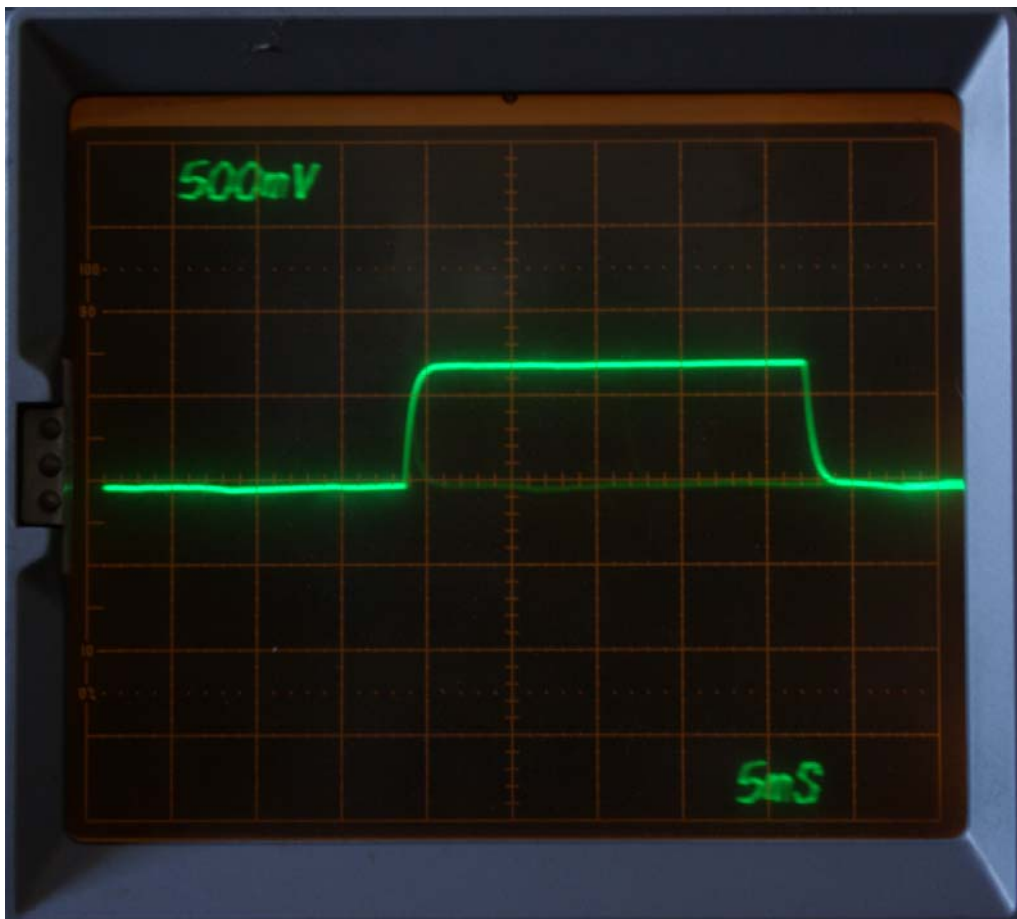
Figura VI.12: Effetto dell'attivazione della bobina sui sensori di campo magnetico
