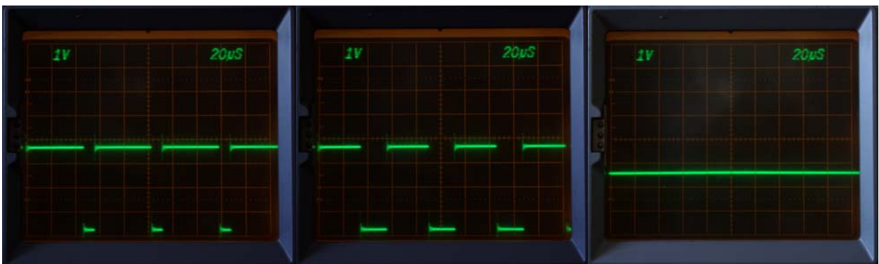
Figura VI.7: Esempi di segnale PWM (sinistra e centro) e segnale in uscita al filtro RC
