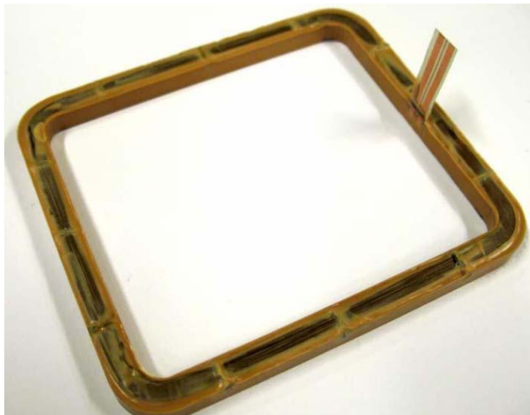
Figura I.1: Esempio di attuatore magnetico tipo bobina [SwissCube: http://swisscube.epfl.ch/ ]
