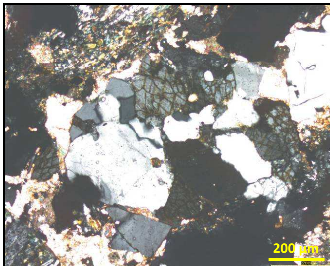
Fig. 4.1.1 Frammento di roccia granitica con cristalli di quarzo, plagioclasti e feldspati (colorati in giallo). Obiettivo 10x , nicols incrociati
