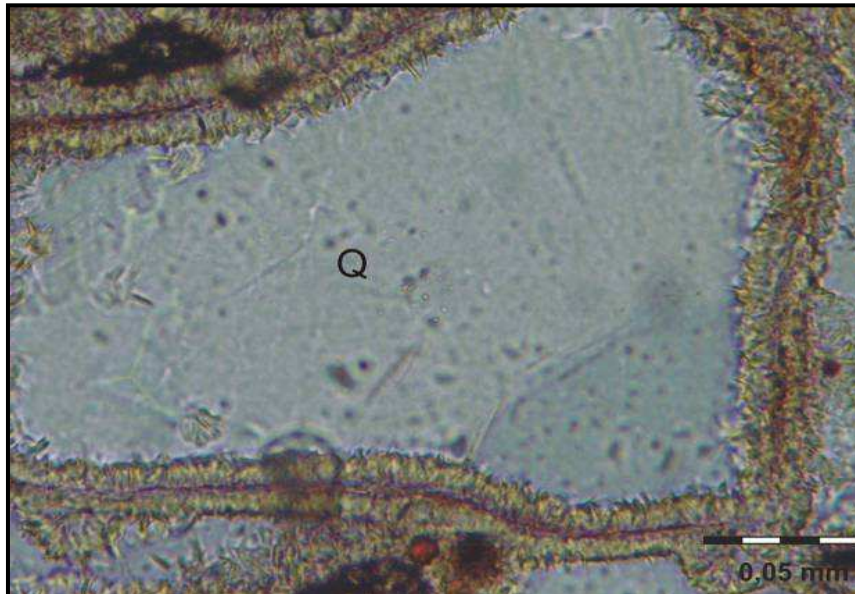
Fig. 6.3.6 Clay rim di clorite attorno ad un granulo di quarzo (si vede l'accrescimento perpendicolare dei cristalli di clorite rispetto al bordo del granulo)
