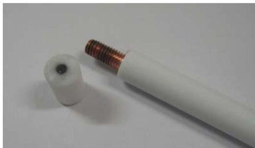
Figura 3.1 – Parti costitutive di un macroelettrodo di GC.
