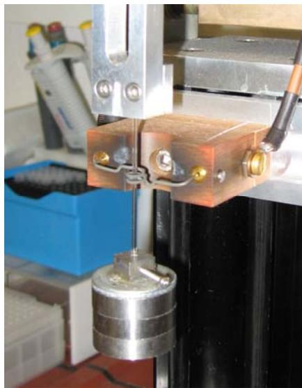
Figura 3.2 – Apparato strumentale per la fabbricazione di microelettrodi di Pt.
