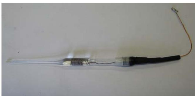
Figura 3.6 – Elettrodo di riferimento Ag/AgCl “home-made”.
