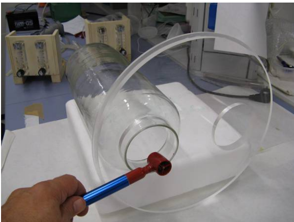
Fig. 14: prova di flusso all'uscita delle camere degli odori.
