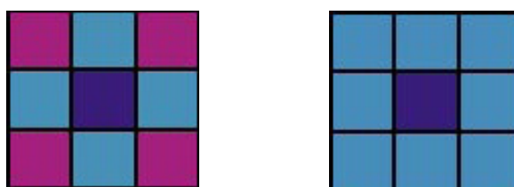
Fig. 3.5 - Esempio di vicinanza piana (a sinistra), nel quale i pixel comuni sono 4, e di vicinanza diagonale (a destra), nel quale i pixel comuni sono 8
