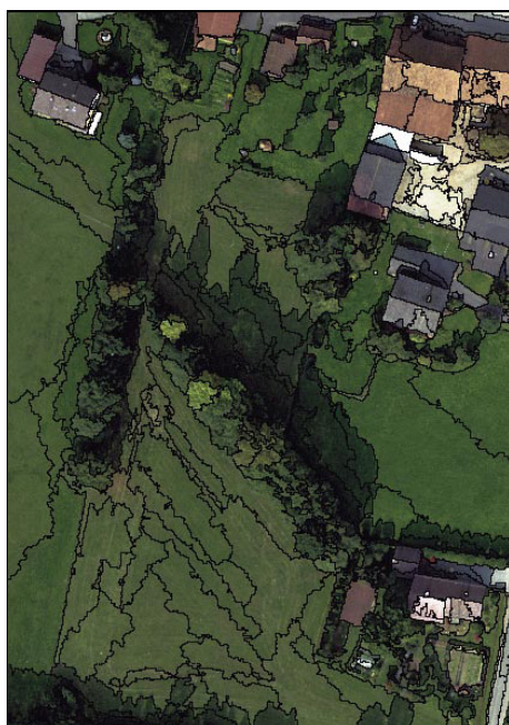
Fig. 3.9 – Risultato di una segmentazione su dati ad alta risoluzione
