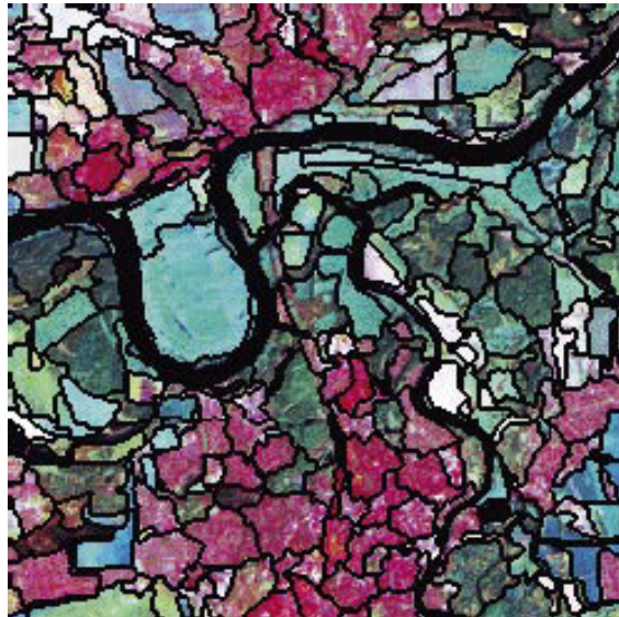
Fig. 3.8 - Esempio di segmentazione di dati LANDSAT tramite i criteri dell'ottimizzazione dell'omogeneità spettrale e spaziale
