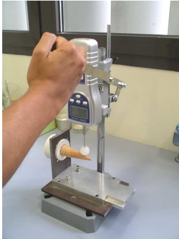
Figura 7.4 Attrezzatura impiegata durante i test di compressione con dinamometro digitale
