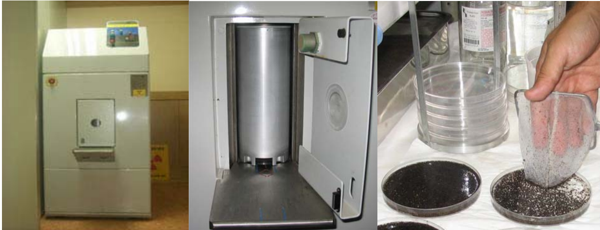
Fig.2.1 - Irradiatore per emoderivati al Cs 137 Mod. IBL437C Type H - CIS Biointernational ® (Ospedale S.Anna di Ferrara - Dip.to di Fisica Sanitaria) - Container per l'alloggiamento del materiale da irraggiare - Posizionamento delle pupe da irraggiare nelle capsule Petri.
