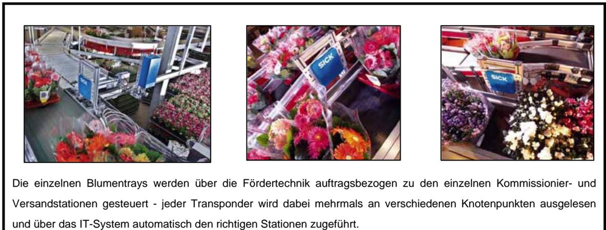
**Abbildung 28: Via Transponder gesteuerter Warenfluss bei der Rutishauser AG<sup>371</sup>**
