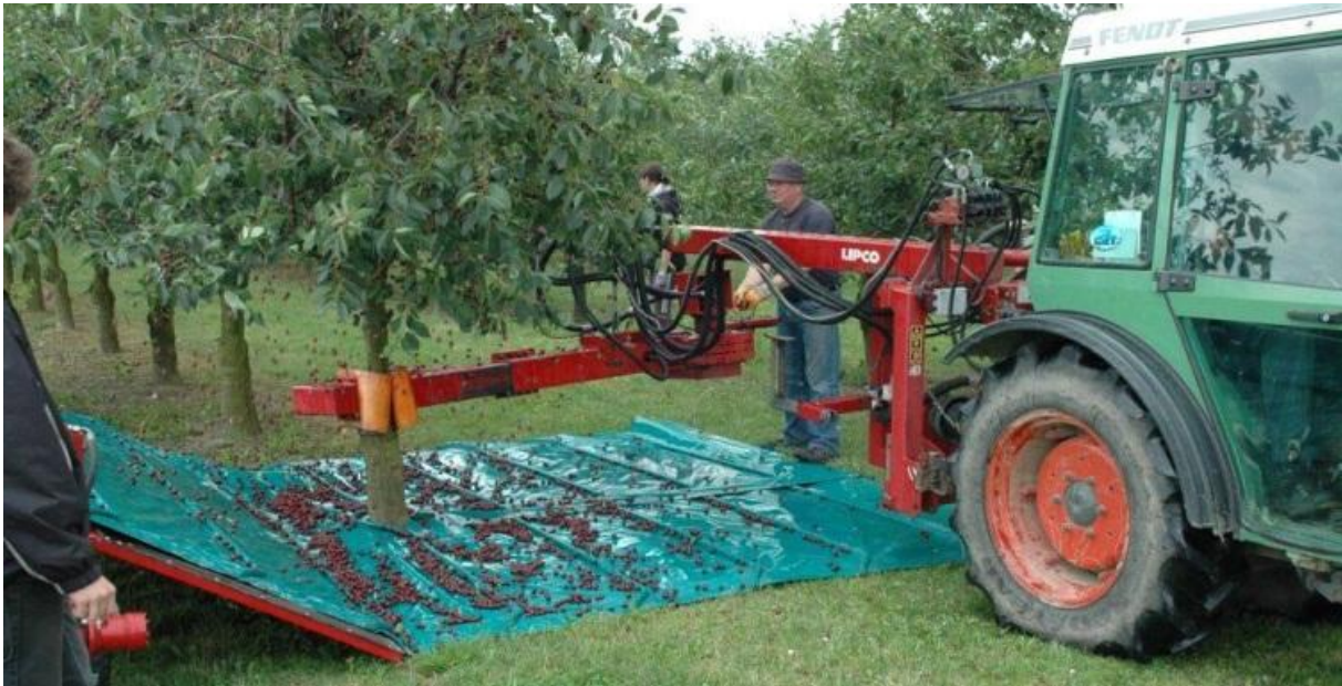
Abbildung 219: Maschinelle Ernte 2011 mit Baumrüttler der Firma Lipco
