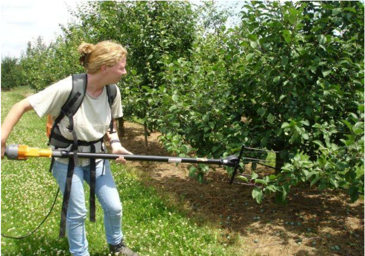
Abbildung 145: Handhabung des Schüttelgerätes „Olivium“
