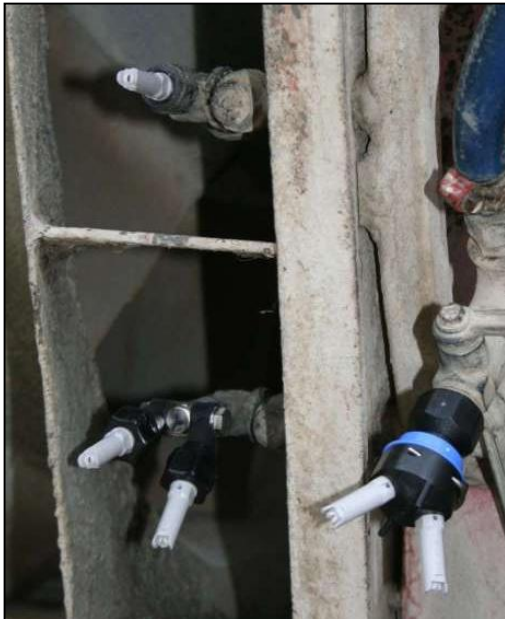
Abbildung 13: Doppelgelenksdüsenträger (links) und TWIN-Spray Cap (rechts) zur Benetzung von Stammbasis und Boden (zum Einsatz kamen 2 Doppelgelenksdüsenträger)
