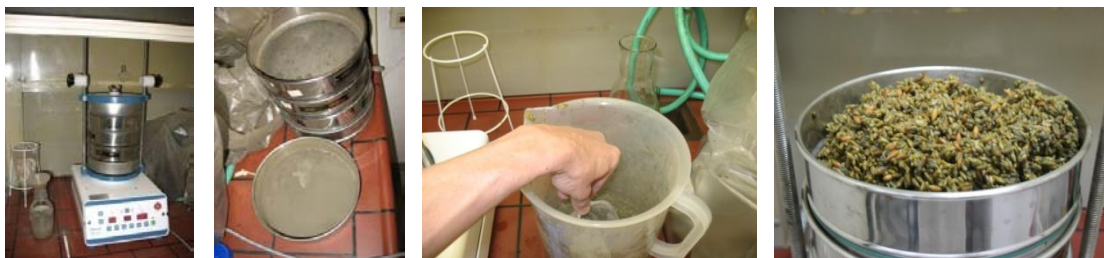
Abbildung 8: Formulierung insektenpathogener Pilze: Links: Zur Herstellung der Ölformulierung wurde das mit dem insektenpathogenen Pilz Ma43 bewachsene Getreide mit Hilfe eines Siebschüttlers (Retsch) mit einer Maschenweite von 150µm gesiebt und als Konidienpulver bis zur Suspendierung in Öl aufbewahrt. Für die wässrigen Formulierungen wurde das mit den Isolaten P4, P8 und Ma43 bewachsene Getreide in Wasser + 0,1% Tween suspendiert (Mitte rechts), und anschließend mit einer Maschenweite von 150µm gesiebt und als Konidien suspension bis zur Ausbringung aufbewahrt.
