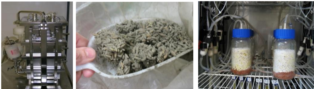
Abbildung 7: Produktion insektenpathogener Pilze im Prophyta Laborfermenter (links) des M. anisopliae Isolates Ma 43 auf Getreide (Mitte) und Produktion von I. fumosorosea in Kleinf fermentern (rechts)
