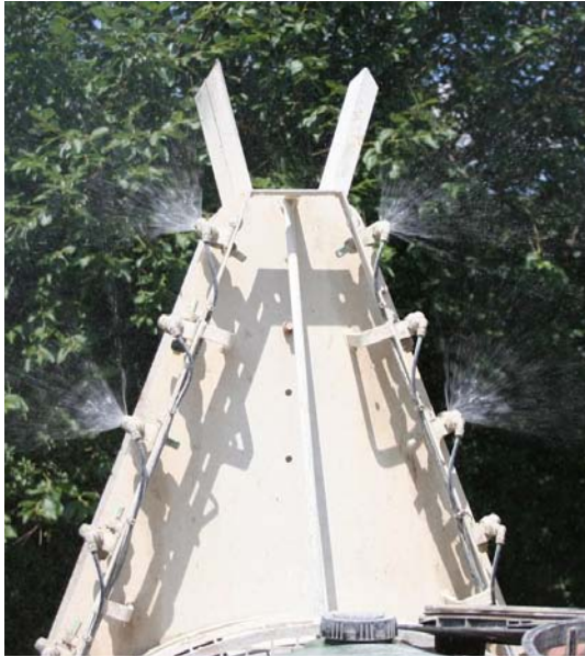
Abbildung 33: Position der 4 Flachstrahldüsen mit der Größe 11015 an der Lochmann RPS 8/80 UQ
