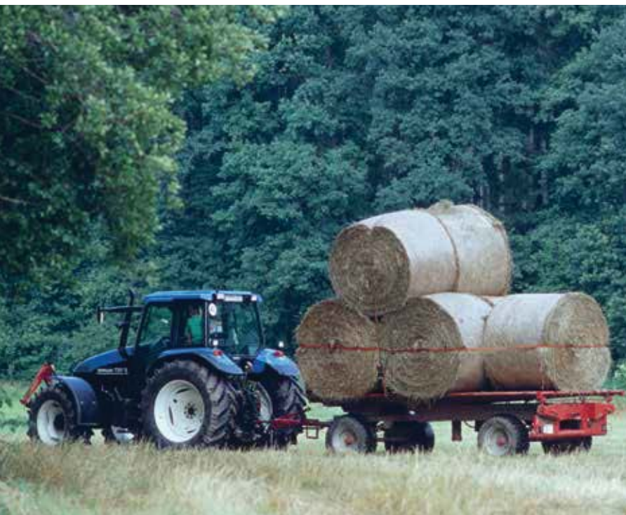
Fahren in grossem Gang bei tiefer Drehzahl vermindert den Treibstoffverbrauch.
