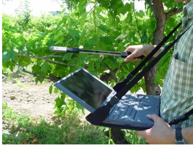
Şekil 2. Yaprak alan indeksi ölçümü cihazı Li-Cor Plant Canopy Analyzer (LAI-2000).
