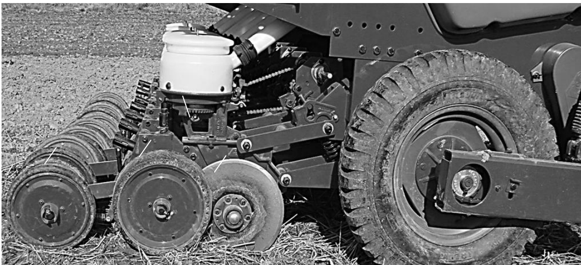
Abb. 1.2: Einzelkorn- Direktsaatmaschine SEMEATO® (Längsschnitt).
