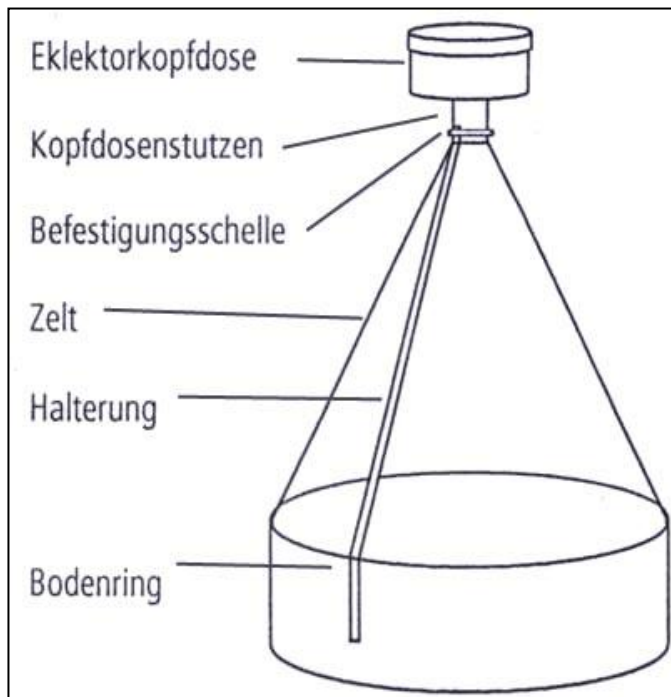
Abb. 1: Schematische Skizze des verwendeten Bodenphotoelektors
