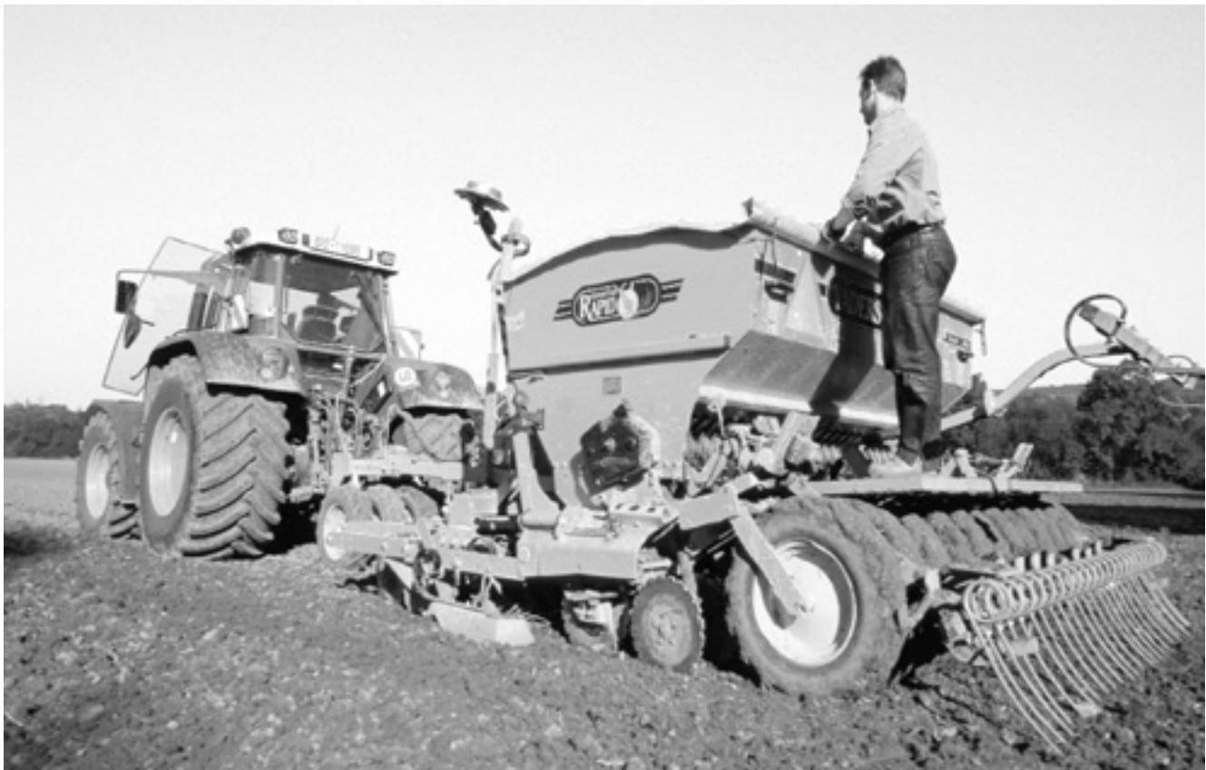
■ Gut für Boden und Energiebilanz: Die Direktsaatmaschine kann auch im ungepflügten Acker säen. (Foto: BLE/Dominic Menzler)
