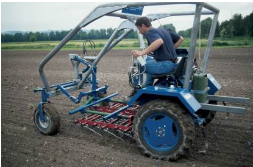
Bild 1) Beetstriegel im Zwischenachseinsatz bei einem Leichtgeräteträger in Rotkohl, ca. eine Woche nach Pflanzung. (René Total ACW Wädenswil, Bild H.U. Dierauer FiBL)
