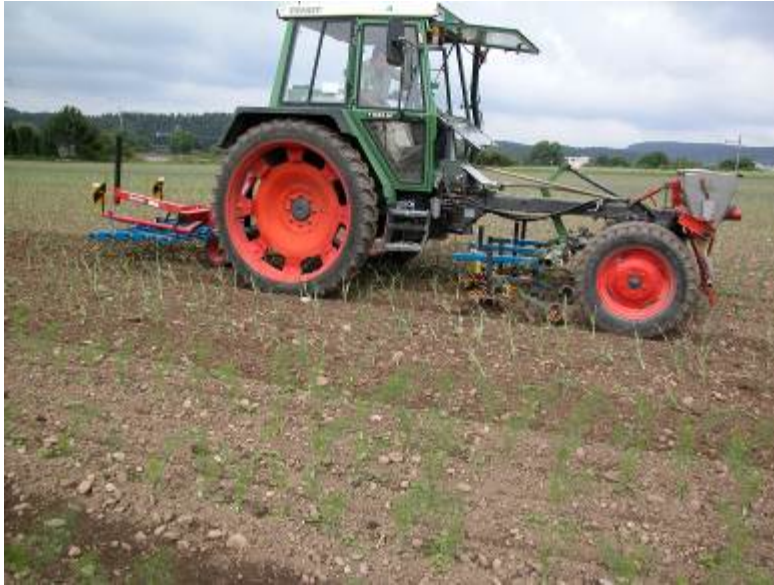
Bild 3) Fingerhacke im Zwischenachsbereich und im Heckanbau ein Beetstriegel mit Radführung für die präzise Höheneinstellung im Lauchanbau (Bild R. Total, ACW Wädenswil)
