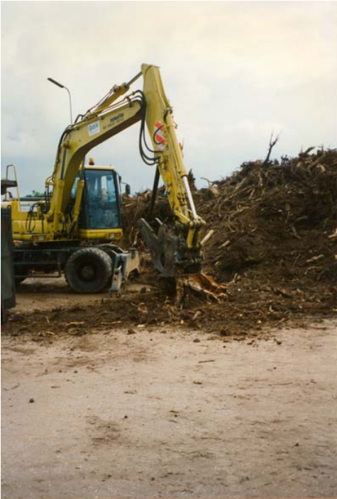
Foto 3. Bewerking stobben met een stobbenschaar.
