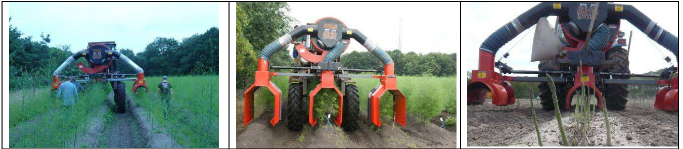
Figuur 1. De ontwikkeling van de Beetle Eater, links 2008 aangepast voor asperges, midden in 2009 verder aangepast voor witte asperges en rechts gebruik kleine kappen gebruikt tijdens de oogst van groene asperges.
