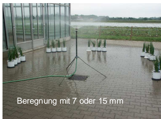
Abb. 17: Versuchsaufbau zur Prüfung der Regenstabilität von Prüfpräparaten an Zwiebel unter Semi-Freilandbedingungen 2008-2010 durch kontrollierte Beregnung und anschließender Inokulation mit Peronospora destructor
