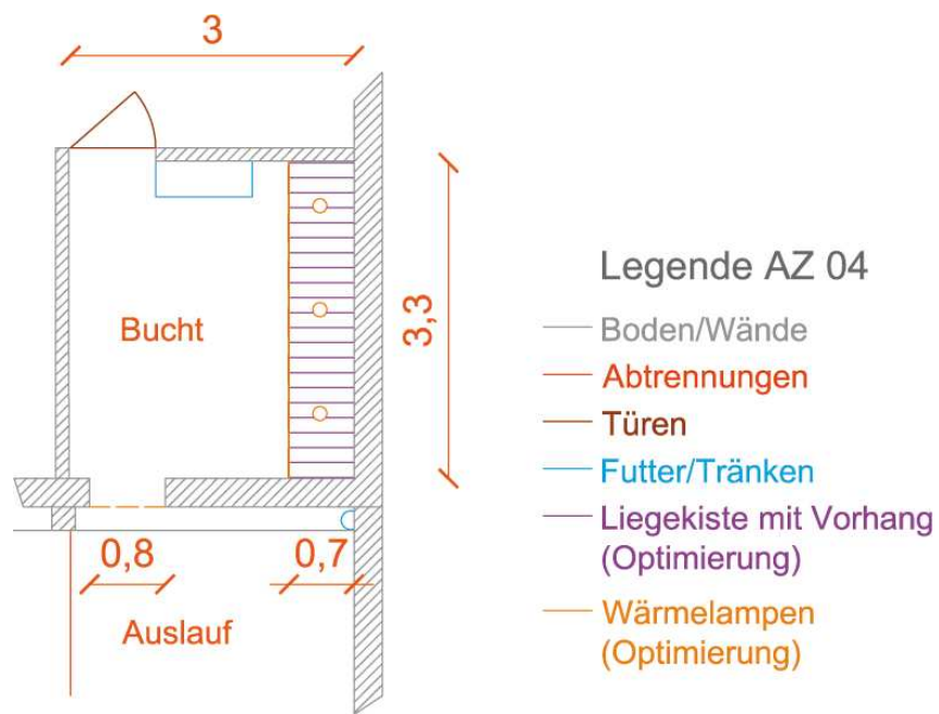
Abb. 35) AZ04: Grundriss Aufzuchtstall mit Auslauf (eig. Abb.)
