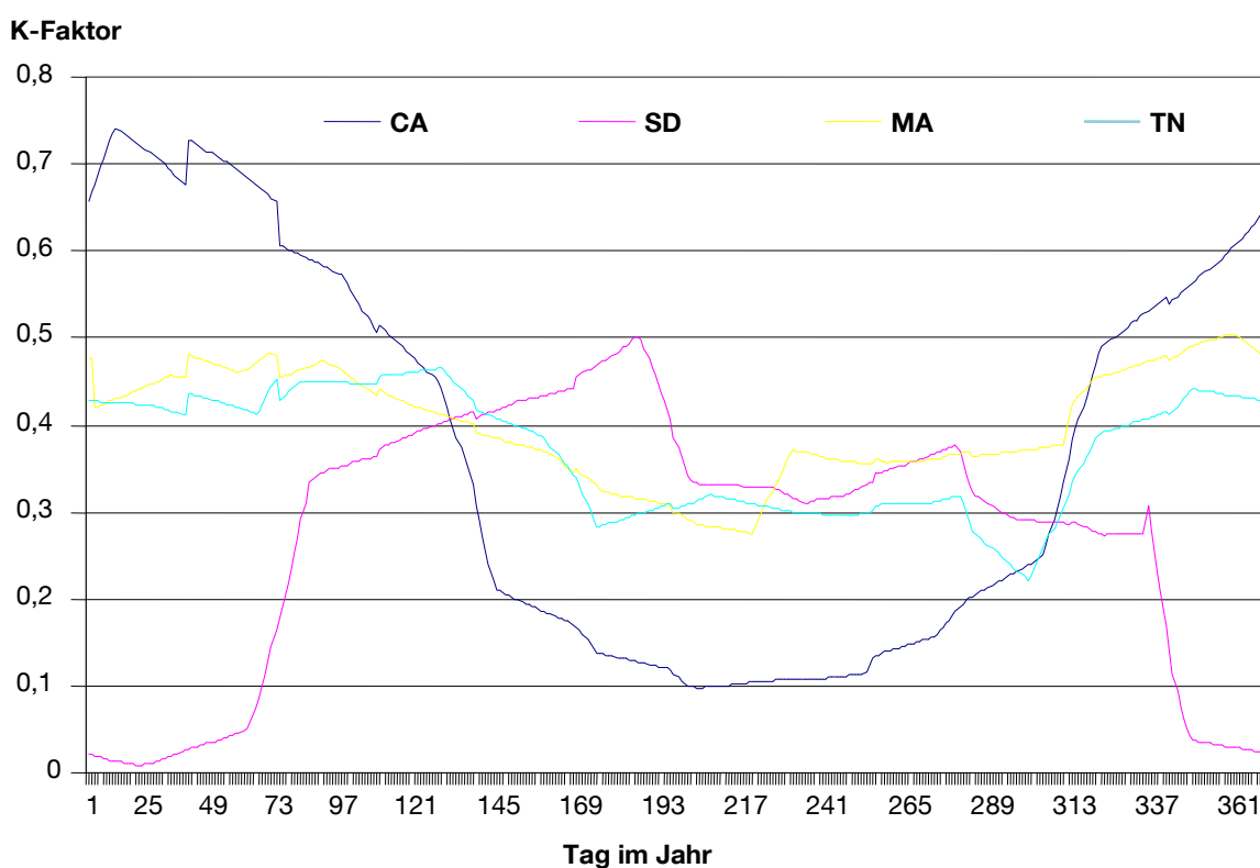
Abb. 10: Beispiel für Jahresverläufe des K-Faktors verschiedener Standorte der USA; CA (Kalifornien), SD (South Dakota), MA (Massachusetts), TN (Tennessee) (Kuenstler 2008)
