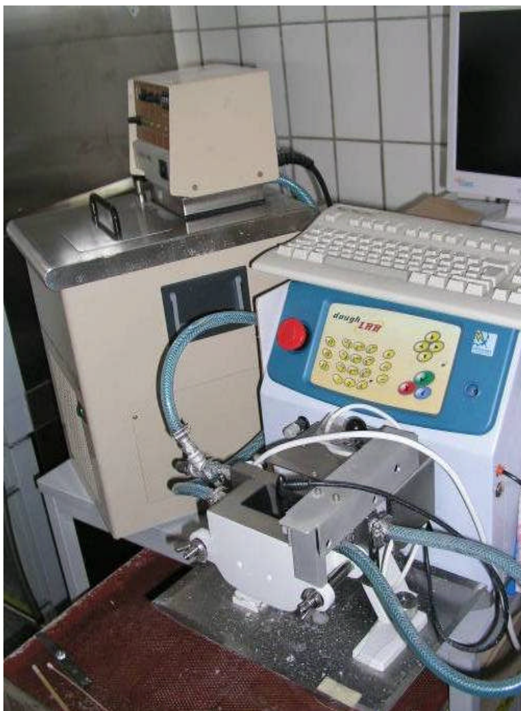
Abb. 3: DoughLab Messkneteter mit Brabender Doppel-Z-Armkneteter für 50 Gramm Mehl mit Temperiereinrichtung (Umlaufkühler, links).
