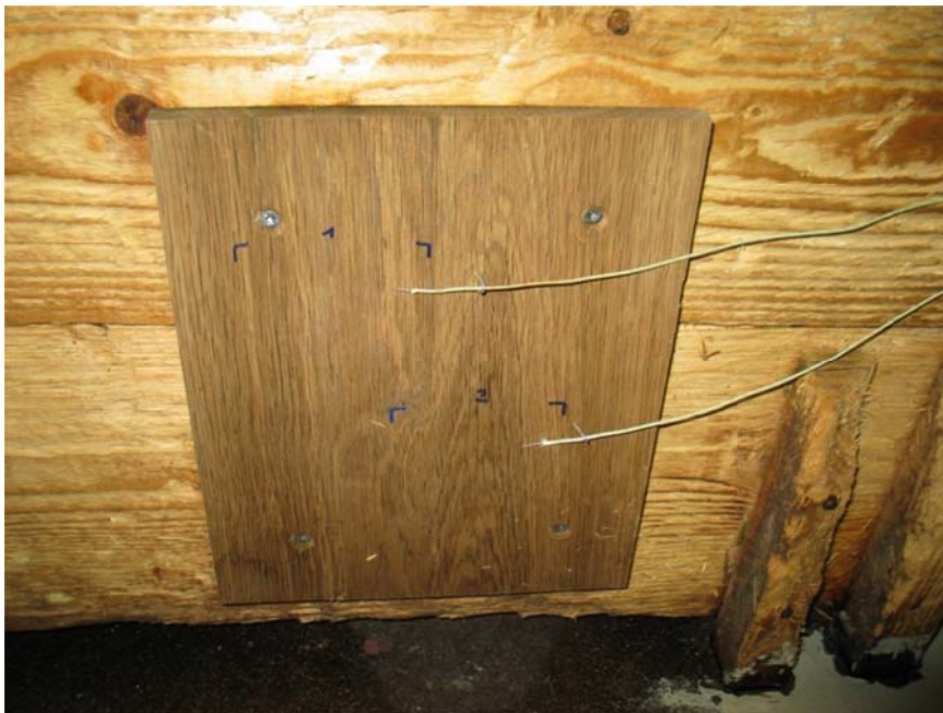
Abbildung 11: Die Temperaturen beim Abflammen wurden auf den Probennahme­flächen 1 und 2 je mit einer Temperatursonde erfasst.
