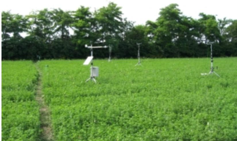
**Abbildung 23:** Die Messstationen der Transektmessung auf der Südost-Seite der Hecke (26. Juni 2003, Bildmitte: die Dauerstation, rechts davon die Windmessungen). Links von der Dauerstation – etwas undeutlich zu erkennen- die eigentlichen Transektmessungen 2003.
