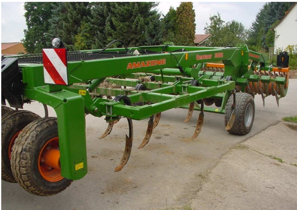
Abb. 5: Kombinationsgrubber Centaur 3002 mit Wendelscharen
