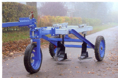
Der Prototyp des „EconDyn“ - ein neu entwickeltes, Pferde gezogenes Spezialgerät für die pfluglose Bodenbearbeitung.
