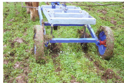
Der Prototyp des „EconDyn“ - ein neu entwickeltes, Pferde gezogenes Spezialgerät für die pfluglose Bodenbearbeitung.
