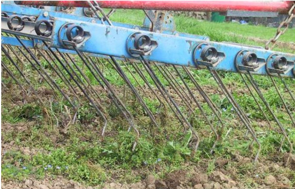
Abbildung 1: Striegel, Fabrikat Hatzenbichler
