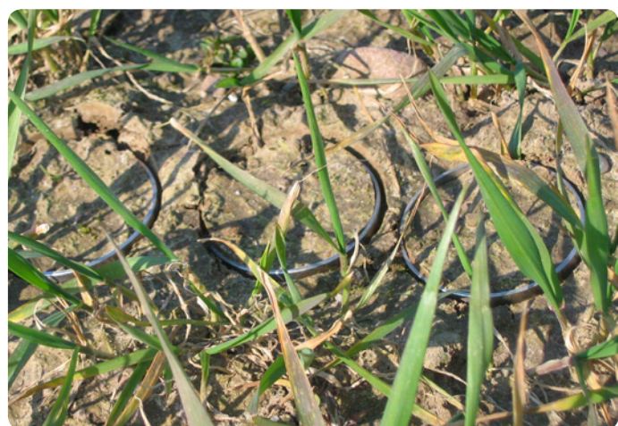
Figur 1A. I alt 72 100-cm 3 ringe blev installeret på hver lokalitet i november, kort efter såning af vinterhvede. De blev udtaget efter en tilfældig procedure i april, maj, juni og august det følgende år. Foto: Søren O. Petersen
