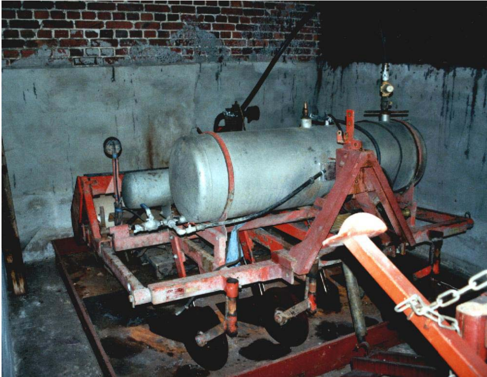
Abbildung 3: Spezialpflug zur Ausbringung von Metham Fluid®
