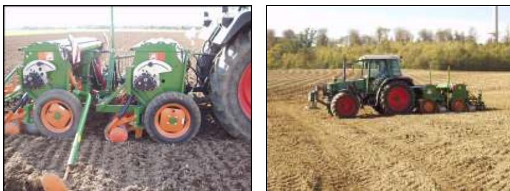
Bild 7: Zwei baugleiche mechanische Drillmaschinen für die Aussaat von Gemengen mit unterschiedlichen Verteilungsmustern (abwechselnde Reihen, Reihen-Streifen-Gemenge), unterstützt durch die Firma Amazone
