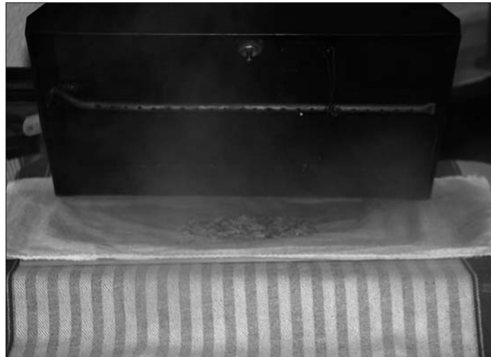
Dampf-Luft Desinfektion von Fenchelsamen im Versuch. Zu sehen ist die Desinfektionskalotte mit auströmendem Dampf. (Foto: ACW)
