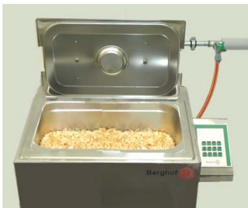
Abb. 2: Keimautomat (KA) der Firma Berghof Elektronik und Umwelttechnik GmbH Nfg KG Keimautomat
