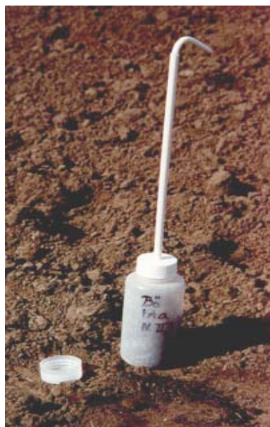
Figur 2. Inkubationsburk med lock och ventilationsrör.
