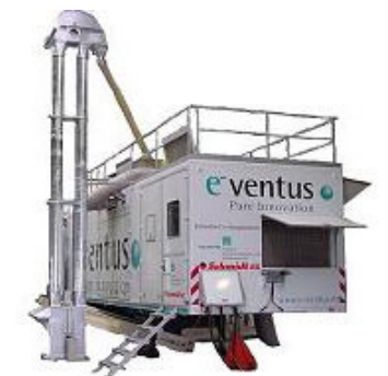
Abbildung 29: Mobile Anlage zur Elektronenbehandlung
