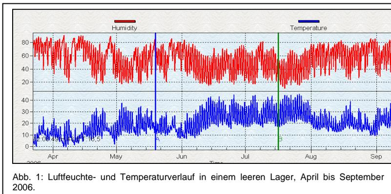
Abb. 1: Luftfeuchte- und Temperaturverlauf in einem leeren Lager, April bis September 2006.
