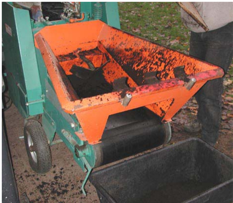
Abb. 4.1.1: Unger Erdpresstopfmaschine „Perfekt“ mit Öffnung zum Substratwechsel
