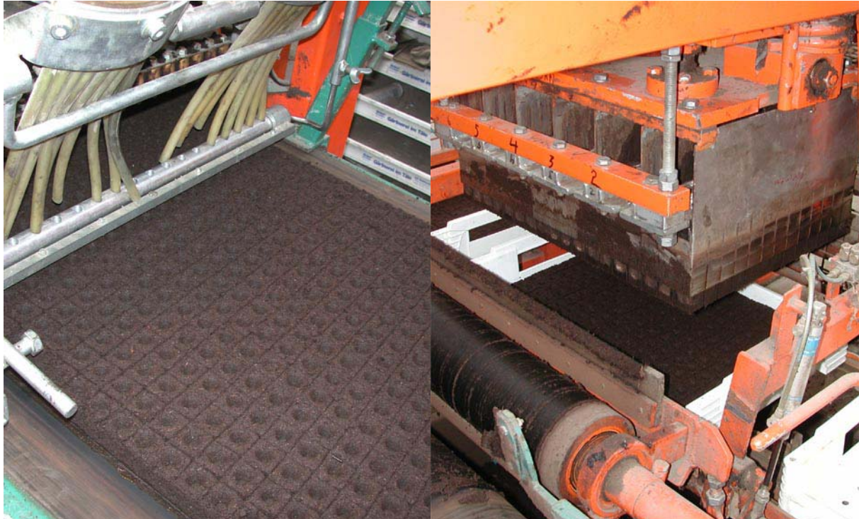
Abb. 4.7.1: Pressen der torfreduzierten Substrate in der Unger Erdtopfmaschine im Betrieb Natterer. (links blick auf die Erdpresslinge vor dem Aufnehmen durch den Stempel; rechts Stempel, davor Andruckwalze, darunter gefüllte Aussaatkiste)
