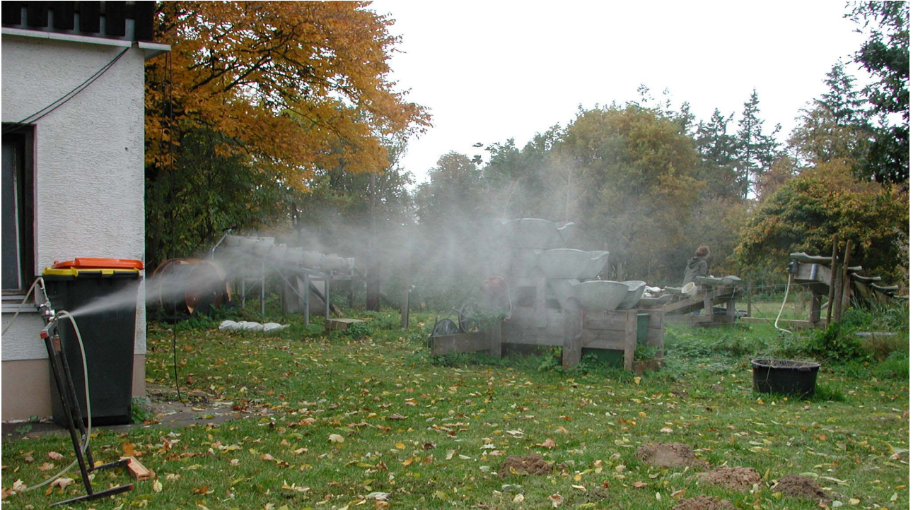
Test einer Zerstäuberdüse zur Ausbringung des Kieselpräparates
