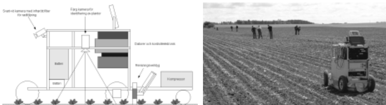
Figur 1. Principskiss och foto av försöksmaskinen. Färgkameran i mitten används för att identifiera de enskilda plantorna och bestämma dess position. Den svartvita kameran används för att identifiera raderna för navigering av roboten.
