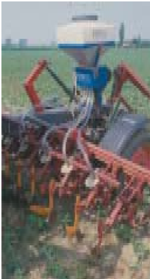
Pneumatische Sämaschine mit kleinen Häufelscharen. Untersaat Gelbsenf in Ackerbohnen
