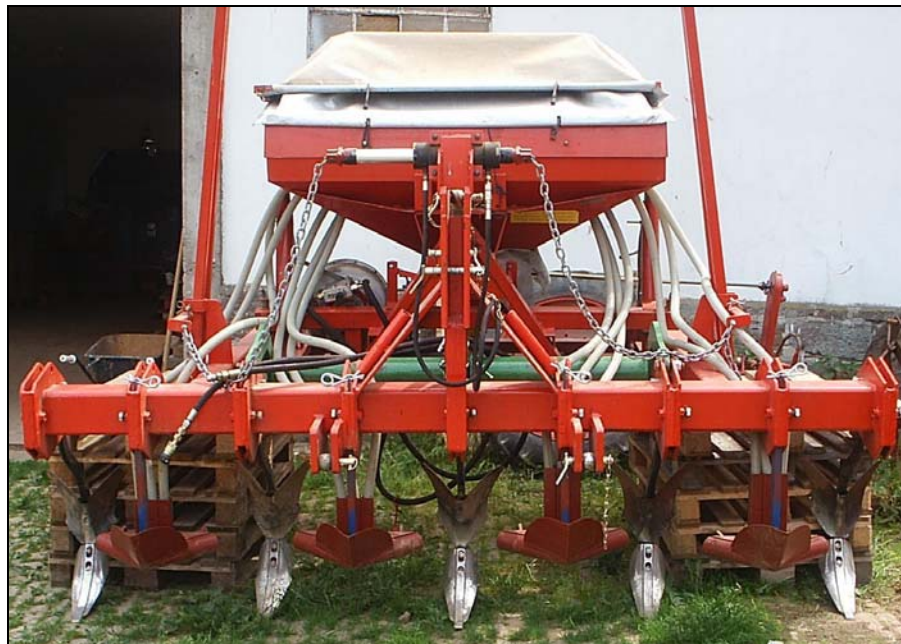
Abb. 5: Dammkulturgerät (Häufelpflug) mit aufgesattelter pneumatischer Sämaschine
