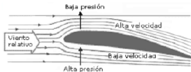
Figura 3.26- Principio de sustentación.
