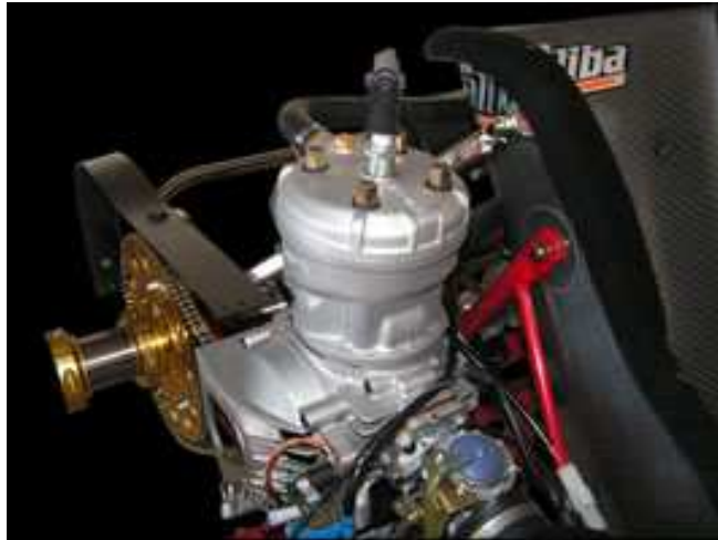
Imagen 1.45 Kart con sistema de refrigeración
