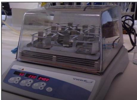
Figura. 2.4. Orbital mini Shaker (VWR. EE.UU)
